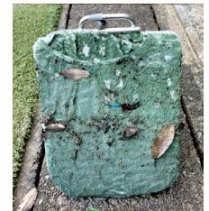
粉状になった人工芝を捕捉した使用後のフィルター
