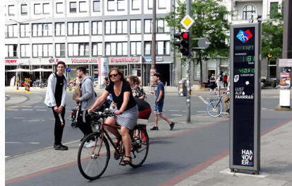
自転車が通ると自動的にカウントする装置
