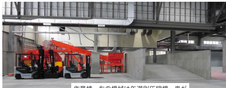
作業棟。左の機械は缶選別圧縮機、奥が缶貯留ヤード、手前がビン作業場
